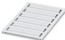
Marcador para bornes, Estera, blanco, sin rotular, rotulable con: TOPMARK NEO, TOPMARK LASER, BLUEMARK ID COLOR, BLUEMARK ID, BLUEMARK CLED, THERMOMARK PRIME, THERMOMARK CARD 2.0, THERMOMARK CARD, clase de montaje: enclavar, para ancho de borne: 3,5 mm, Número de índices individuales: 102, altura del campo de texto: 10,5 mm, anchura del campo de texto: 2,95 mm
