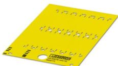
Marcador de cables, Tarjeta, amarillo, sin rotular, rotulable con: BLUEMARK ID COLOR, BLUEMARK ID, THERMOMARK PRIME, THERMOMARK CARD 2.0, THERMOMARK CARD, clase de montaje: Montaje con sujetacables, diámetro de cable: > 13 mm, Número de índices individuales: 12, altura del campo de texto: 15 mm, anchura del campo de texto: 44 mm
