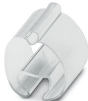
Soporte para señalización de conductores, transparente, sin rotular, clase de montaje: deslizamiento, rango de diámetro de cable: 14 ... 22 mm, altura del campo de texto: 4 mm, anchura del campo de texto: 18 mm
