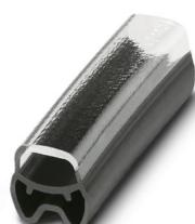
Soporte para señalización de conductores, transparente/negro, sin rotular, clase de montaje: deslizamiento, rango de diámetro de cable: 1,3 ... 2,8 mm, altura del campo de texto: 4 mm, anchura del campo de texto: 18 mm
