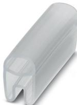
Soporte para señalización de conductores, transparente, sin rotular, clase de montaje: deslizamiento, rango de diámetro de cable: 2 ... 4 mm, altura del campo de texto: 4 mm, anchura del campo de texto: 18 mm
