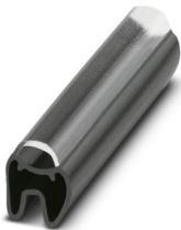
Soporte para señalización de conductores, transparente/negro, sin rotular, clase de montaje: deslizamiento, rango de diámetro de cable: 2 ... 4 mm, altura del campo de texto: 4 mm, anchura del campo de texto: 18 mm
