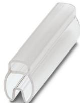
Soporte para señalización de conductores, transparente, sin rotular, clase de montaje: deslizamiento, rango de diámetro de cable: 4 ... 7 mm, altura del campo de texto: 4 mm
