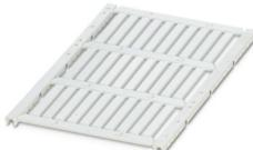
Marcador de conductores, Estera, blanco, sin rotular, rotulable con: TOPMARK NEO, TOPMARK LASER, BLUEMARK ID COLOR, BLUEMARK ID, BLUEMARK CLED, THERMOMARK PRIME, THERMOMARK CARD 2.0, THERMOMARK CARD, clase de montaje: introducir, rango de diámetro de cable: 1,5 ... 14 mm, Número de índices individuales: 30, altura del campo de texto: 4 mm, anchura del campo de texto: 30 mm
