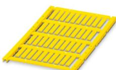
Marcador de conductores, Estera, amarillo, sin rotular, rotulable con: TOPMARK NEO, TOPMARK LASER, BLUEMARK ID COLOR, BLUEMARK ID, BLUEMARK CLED, THERMOMARK PRIME, THERMOMARK CARD 2.0, THERMOMARK CARD, clase de montaje: introducir, rango de diámetro de cable: 0,6 ... 22 mm, Número de índices individuales: 40, altura del campo de texto: 4 mm, anchura del campo de texto: 18 mm
