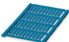
Marcador de conductores, Estera, azul, sin rotular, rotulable con: TOPMARK NEO, TOPMARK LASER, BLUEMARK ID COLOR, BLUEMARK ID, BLUEMARK CLED, THERMOMARK PRIME, THERMOMARK CARD 2.0, THERMOMARK CARD, clase de montaje: introducir, rango de diámetro de cable: 0,6 ... 22 mm, Número de índices individuales: 40, altura del campo de texto: 4 mm, anchura del campo de texto: 18 mm
