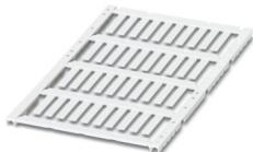
Marcador de conductores, Estera, blanco, sin rotular, rotulable con: TOPMARK NEO, TOPMARK LASER, BLUEMARK ID COLOR, BLUEMARK ID, BLUEMARK CLED, THERMOMARK PRIME, THERMOMARK CARD 2.0, THERMOMARK CARD, clase de montaje: introducir, rango de diámetro de cable: 0,6 ... 22 mm, Número de índices individuales: 40, altura del campo de texto: 4 mm, anchura del campo de texto: 18 mm
