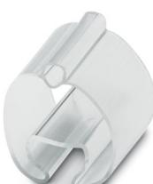
Soporte para señalización de conductores, transparente, sin rotular, clase de montaje: deslizamiento, rango de diámetro de cable: 14 ... 22 mm, altura del campo de texto: 4 mm, anchura del campo de texto: 18 mm
