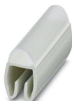
Soporte para señalización de conductores, transparente, sin rotular, clase de montaje: enganchar, rango de diámetro de cable: 2,8 ... 4,4 mm, altura del campo de texto: 4 mm, anchura del campo de texto: 18 mm
