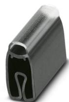
Soporte para señalización de conductores, transparente/negro, sin rotular, clase de montaje: deslizamiento, rango de diámetro de cable: 5 ... 10 mm, altura del campo de texto: 4 mm, anchura del campo de texto: 18 mm
