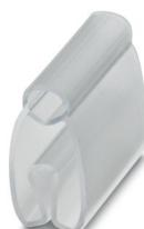
Soporte para señalización de conductores, transparente, sin rotular, clase de montaje: deslizamiento, rango de diámetro de cable: 6 ... 10 mm, altura del campo de texto: 4 mm
