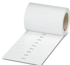
Tira de rotulación, Rollo, transparente, sin rotular, rotulable con: THERMOMARK E.300 (D)/600 (D), THERMOMARK ROLL 2.0, THERMOMARK ROLL, THERMOMARK ROLL X1, THERMOMARK ROLMASTER 300/600, THERMOMARK X1.2, clase de montaje: pegado, para ancho de borne: 101 mm, Número de índices individuales: 1000, altura del campo de texto: 9,5 mm, anchura del campo de texto: 101 mm
