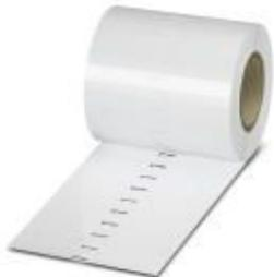
Marcador para bornes, Rollo, blanco, sin rotular, rotulable con: THERMOMARK ROLL 2.0, THERMOMARK ROLL, THERMOMARK ROLL X1, THERMOMARK ROLLMASTER 300/600, THERMOMARK X1.2, THERMOMARK S1.1, Perforado, clase de montaje: encajar en ranura de etiqueta universal, encajar en ranura para índice plana, para ancho de borne: 5,2 mm, superficie útil: 6,4 x 5,15 mm, Número de índices individuales: 19000
