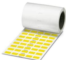
Etiqueta, Rollo, amarillo, sin rotular, rotulable con: THERMOMARK E.300 (D)/600 (D), THERMOMARK ROLL 2.0, THERMOMARK ROLL, THERMOMARK ROLL X1, THERMOMARK ROLLMASTER 300/600, THERMOMARK X1.2, clase de montaje: pegado, Número de índices individuales: 2500, altura del campo de texto: 9 mm, anchura del campo de texto: 15 mm
