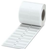
Etiqueta, Rollo, plata, sin rotular, rotulable con: THERMOMARK E.300 (D)/600 (D), THERMOMARK ROLL 2.0, THERMOMARK ROLL, THERMOMARK ROLL X1, THERMOMARK ROLLMASTER 300/600, THERMOMARK X1.2, clase de montaje: pegado, Número de índices individuales: 2500, altura del campo de texto: 15 mm, anchura del campo de texto: 40 mm
