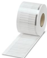
Marcador de cables, Rollo, blanco, sin rotular, rotulable con: THERMOMARK E. 300 (D)/600 (D), THERMOMARK ROLL 2.0, THERMOMARK ROLL, THERMOMARK ROLL X1, THERMOMARK ROLLMASTER 300/600, THERMOMARK X1.2, clase de montaje: introducir, rango de diámetro de cable: 1,5 ... 35 mm, Número de índices individuales: 3000, altura del campo de texto: 4 mm, anchura del campo de texto: 23 mm
