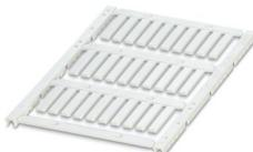
Marcador de conductores, Estera, blanco, sin rotular, rotulable con: TOPMARK NEO, TOPMARK LASER, BLUEMARK ID COLOR, BLUEMARK ID, BLUEMARK CLED, THERMOMARK PRIME, THERMOMARK CARD 2.0, THERMOMARK CARD, clase de montaje: introducir, rango de diámetro de cable: 1,5 ... 35 mm, Número de índices individuales: 30, altura del campo de texto: 4 mm, anchura del campo de texto: 23 mm
