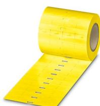
Rótulo insertable, Rollo, amarillo, sin rotular, rotulable con: THERMOMARK E.300 (D)/600 (D), THERMOMARK ROLL 2.0, THERMOMARK ROLL, THERMOMARK ROLL X1, THERMOMARK ROLLMASTER 300/600, THERMOMARK X1.2, clase de montaje: introducir, rango de diámetro de cable: 1,5 ... 35 mm, Número de índices individuales: 5000, altura del campo de texto: 4 mm, anchura del campo de texto: 23 mm
