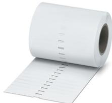
Tira de rotulación, Rollo, blanco, sin rotular, rotulable con: THERMOMARK E.300 (D)/600 (D), THERMOMARK ROLL 2.0, THERMOMARK ROLL, THERMOMARK ROLL X1, THERMOMARK ROLLMASTER 300/600, THERMOMARK X1.2, clase de montaje: pegado, para ancho de borne: 104 mm, Número de índices individuales: 2500, altura del campo de texto: 2,8 mm, anchura del campo de texto: 104 mm
