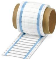
Manguito termorretráctil, Rollo, blanco, sin rotular, rotulable con: THERMOMARK E.300 (D)/600 (D), THERMOMARK ROLLMASTER 300/600, THERMOMARK ROLL X1, THERMOMARK ROLL, THERMOMARK ROLL 2.0, THERMOMARK W, THERMOMARK X1.2, Perforado, clase de montaje: deslizamiento, rango de diámetro de cable: 2,1 ... 6,4 mm, Número de índices individuales: 1000, altura del campo de texto: 10 mm, anchura del campo de texto: 15 mm
