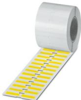
Etiqueta de tejido, Rollo, amarillo, sin rotular, rotulable con: THERMOMARK E.300 (D)/600 (D), THERMOMARK ROLL 2.0, THERMOMARK ROLL, THERMOMARK ROLL X1, THERMOMARK ROLLMASTER 300/600, THERMOMARK X1.2, clase de montaje: pegado, Número de índices individuales: 2500, altura del campo de texto: 8 mm, anchura del campo de texto: 25 mm
