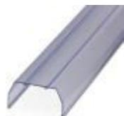
Perfil cobertor, para tapar regletas de bornes, se encaja en los soportes AP 3-TU, AP 3-TNS 35, rotulable con tiras de rotulación AP-ES. En los extremos, y a unas distancias de aprox. 40 cm, debe insertarse un soporte para perfil cobertor. Longitud de suministro: según indicaciones cliente
