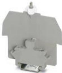
Soporte para perfil cobertor precintable, para montaje sobre carril NS 35/7,5 y fijación del perfil cobertor AP 3, con tuerca moleteada de plástico M5, espacio necesario: 13 mm
