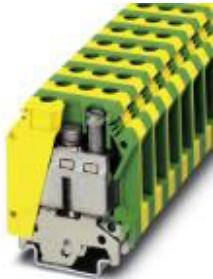
Borne de tierra para carril, tipo de conexión: Conexión por tornillo, número de conexiones: 2, sección: 0,75 mm<sup>2</sup> - 50 mm<sup>2</sup>, AWG: 18 - 1/0, anchura: 15,2 mm, color: amarillo-verde, clase de montaje: NS 35/7,5, NS 35/15, NS 32
