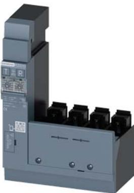
Aparato de protección de corriente diferencial RCD210 Basic RCD Tipo A montaje lateral Corriente nominal de defecto 0,03...5 A a 50/60 Hz tv ajustable 0...3000ms 4 polos In=160 A Ue=127-480V Accesorio para: 3VM con conexión en borne
