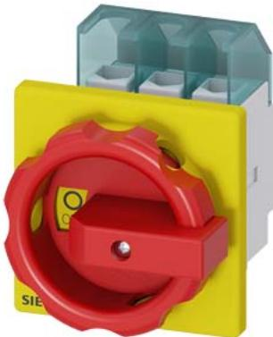
SENTRON, interruptor-seccionador 3LD, Pulsador de parada de emergencia, 3 polos, I<sub>u</sub>: 32 A, Potencia de empleo / con AC-23 A a 400 V: 11,5 kW, con fijación frontal, Accionamiento giratorio, rojo/amarillo, Fijación por 4 taladros de la maneta
