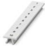
Tira Zack, Tiras, blanco, rotulado, rotulable con: CMS-P1-PLOTTER, Rotulación transversal: números correlativos de 1 ... 10, 11 ... 20 etc. hasta 491 ... 500, clase de montaje: encajar en ranura para índice alta, para ancho de borne: 6,2 mm, superficie útil: 6,15 x 10,5 mm, Número de índices individuales: 10
