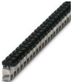
Borne de conexión, tipo de conexión: Conexión por tornillo, corriente de carga: 125 A, sección: 2,5 mm<sup>2</sup> - 35 mm<sup>2</sup>, anchura: 14,3 mm, color: negro
