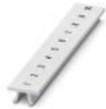
Tira Zack, Tiras, blanco, rotulado, rotulable con: CMS-P1-PLOTTER, rotulación longitudinal: números correlativos de 1 ... 10, 11 ... 20 etc. hasta 491 ... 500, clase de montaje: encajar en ranura para índice alta, para ancho de borne: 6,2 mm, superficie útil: 6,15 x 10,5 mm, Número de índices individuales: 10
