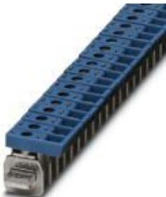
Borne de conexión, tipo de conexión: Conexión por tornillo, corriente de carga: 41 A, sección: 0,5 mm<sup>2</sup> - 6 mm<sup>2</sup>, anchura: 7 mm, color: azul
