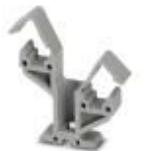
Caballete doble, de material aislante, opcionalmente utilizable para barra colectora 3 x 10 mm o 6 x 6 mm, altura cuando está cerrado: 39 mm
