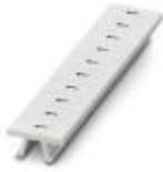
Tira Zack, Tiras, blanco, rotulado, rotulable con: CMS-P1-PLOTTER, rotulación longitudinal: Números iguales 1 o 2 etc. hasta 100, clase de montaje: encajar en ranura para índice alta, para ancho de borne: 5,2 mm, superficie útil: 5,15 x 10,5 mm, Número de índices individuales: 10
