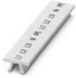
Tira Zack, Tiras, blanco, rotulado, longitudinal: L1, L2, L3, N, PE, L1, L2, L3, N, PE, clase de montaje: encajar en ranura para índice alta, para ancho de borne: 5,2 mm, superficie útil: 5,15 x 10,5 mm, Número de índices individuales: 10
