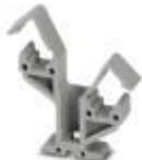
Caballete doble, de material aislante, opcionalmente utilizable para barra colectora 3 x 10 mm o 6 x 6 mm, altura cuando está cerrado: 39 mm
