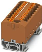
Bloque para distribución, Bloque con alineación horizontal y alimentación integrada, tensión nominal: 690 V, corriente nominal: 24 A, número de conexiones: 19, tipo de conexión: Conexión push-in, Derivación, sección: 0,14 mm<sup>2</sup> - 4 mm<sup>2</sup>, Conexión push-in, Conexión colectiva, Sección de dimensionamiento: 6 mm<sup>2</sup>, sección: 0,5 mm<sup>2</sup> - 10 mm<sup>2</sup>, clase de montaje: NS 15, color: marrón
