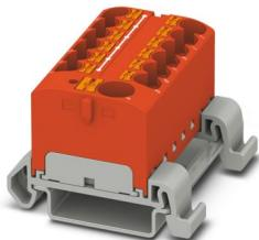
Bloque para distribución, tensión nominal: 800 V, corriente nominal: 32 A, número de conexiones: 13, tipo de conexión: Conexión push-in, Derivación, sección: 0,2 mm<sup>2</sup> - 6 mm<sup>2</sup>, Conexión push-in, Conexión colectiva, Sección de dimensionamiento: 10 mm<sup>2</sup>, sección: 0,5 mm<sup>2</sup> - 10 mm<sup>2</sup>, clase de montaje: NS 35/7,5, NS 35/15, color: rojo
