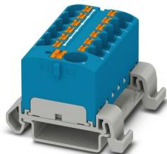
Bloque para distribución, tensión nominal: 800 V, corriente nominal: 32 A, número de conexiones: 13, tipo de conexión: Conexión push-in, Derivación, sección: 0,2 mm<sup>2</sup> - 6 mm<sup>2</sup>, Conexión push-in, Conexión colectiva, Sección de dimensionamiento: 10 mm<sup>2</sup>, sección: 0,5 mm<sup>2</sup> - 10 mm<sup>2</sup>, clase de montaje: NS 35/7,5, NS 35/15, color: azul
