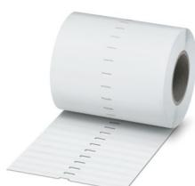
Tira de rotulación, Rollo, blanco, sin rotular, rotulable con: THERMOMARK E. 300 (D)/600 (D), THERMOMARK ROLL 2.0, THERMOMARK ROLL, THERMOMARK ROLL X1, THERMOMARK ROLLMASTER 300/600, THERMOMARK X1.2, clase de montaje: pegado, para ancho de borne: 104 mm, Número de índices individuales: 2500, altura del campo de texto: 3,8 mm, anchura del campo de texto: 104 mm
