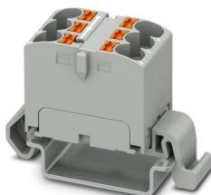
Bloque para distribución, Bloque con alineación horizontal, tensión nominal: 800 V, corriente nominal: 32 A, número de conexiones: 6, tipo de conexión: Conexión push-in, sección: 0,2 mm<sup>2</sup> - 6 mm<sup>2</sup>, clase de montaje: NS 35/7,5, NS 35/15, color: gris
