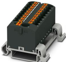
Bloque para distribución, Bloque con alineación horizontal y alimentación integrada, tensión nominal: 690 V, corriente nominal: 24 A, número de conexiones: 19, tipo de conexión: Conexión push-in, Derivación, sección: 0,14 mm<sup>2</sup> - 4 mm<sup>2</sup>, Conexión push-in, Conexión colectiva, Sección de dimensionamiento: 6 mm<sup>2</sup>, sección: 0,5 mm<sup>2</sup> - 10 mm<sup>2</sup>, clase de montaje: NS 35/7,5, NS 35/15, color: negro
