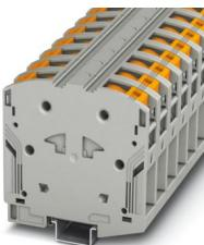
Borne de corriente, tensión nominal: 1000 V, corriente nominal: 232 A, número de conexiones: 2, número de polos: 1, tipo de conexión: Conexión PowerTurn, sección: 25 mm<sup>2</sup> - 95 mm<sup>2</sup>, clase de montaje: NS 35/15, color: gris
