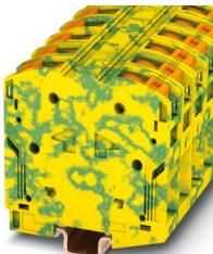
Borna de tierra, número de conexiones: 2, número de polos: 1, tipo de conexión: Conexión PowerTurn, 1er piso, sección: 10 mm<sup>2</sup> - 70 mm<sup>2</sup>, clase de montaje: NS 35/15, color: amarillo-verde
