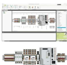
Software de planificación y marcado intuitivo para diseñar regleteros de bornes y para la rotulación profesional de materiales de marcado para bornes, conductores, equipos e instalaciones. El software está disponible para su descarga
