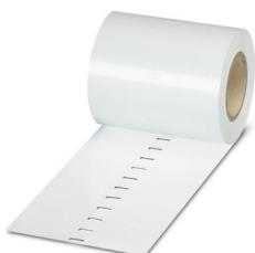
Marcador para bornes, Rollo, blanco, sin rotular, rotulable con: THERMOMARK ROLL 2.0, THERMOMARK ROLL, THERMOMARK ROLL X1, THERMOMARK ROLLMASTER 300/600, THERMOMARK X1.2, THERMOMARK S1.1, Perforado, clase de montaje: enclavar, encajar en ranura para índice plana, para ancho de borne: 10,2 mm, Número de índices individuales: 10000, altura del campo de texto: 6,35 mm, anchura del campo de texto: 10,15 mm
