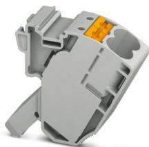
Borna de derivación, tensión nominal: 1500 V, corriente nominal: 57 A, número de conexiones: 2, tipo de conexión: Conexión push-in, 1er piso, Sección de dimensionamiento: 10 mm<sup>2</sup>, sección: 0,5 mm<sup>2</sup> - 16 mm<sup>2</sup>, clase de montaje: en elemento de base, color: gris
