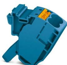
Borna de derivación, tensión nominal: 1500 V, corriente nominal: 57 A, número de conexiones: 2, tipo de conexión: Conexión push-in, 1er piso, Sección de dimensionamiento: 10 mm<sup>2</sup>, sección: 0,5 mm<sup>2</sup> - 16 mm<sup>2</sup>, clase de montaje: en elemento de base, color: azul
