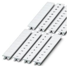
Marcador para bornes, Tiras, blanco, rotulado, rotulable con: CMS-P1-PLOTTER, longitudinal: L1, L2, L3, N, PE, L1, L2, L3, N, PE, clase de montaje: enclavar, para ancho de borne: 8,2 mm, Número de índices individuales: 10, altura del campo de texto: 10,5 mm, anchura del campo de texto: 8,15 mm
