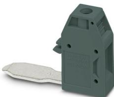
Borna de derivación, encajable, para la conexión de secciones pequeñas, tensión nominal: 1000 V, corriente nominal: 57 A, número de conexiones: 1, tipo de conexión: Conexión especial y mixta, Sección de dimensionamiento: 10 mm<sup>2</sup>, sección: 0,5 mm<sup>2</sup> - 10 mm<sup>2</sup>, clase de montaje: en elemento de base, color: gris oscuro
