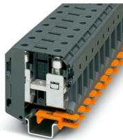
Borne de paso, tensión nominal: 1000 V, corriente nominal: 192 A, número de conexiones: 2, tipo de conexión: Conexión por tornillo, Sección de dimensionamiento: 70 mm<sup>2</sup>, sección: 16 mm<sup>2</sup> - 95 mm<sup>2</sup>, clase de montaje: NS 35/7,5, NS 35/15, color: gris oscuro
