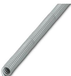
Manguera de protección, material: PVC, espiral: PVC Acero para resortes con revestimiento, resistente a los rayos ultravioleta: no, flexible, índice de protección: IP68, color: gris, diámetro interior: 13 mm, Longitud total: 10 m
