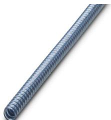
Manguera de protección, material: PU, espiral: PUR Acero para resortes con revestimiento, resistente a los rayos ultravioleta: no, flexible, índice de protección: IP68, color: azul, clase de inflamabilidad según UL 94: V2, diámetro interior: 10 mm, Longitud total: 10 m
