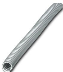
Manguera de protección, material: PVC, espiral: PVC Acero para resortes con revestimiento, resistente a los rayos ultravioleta: no, flexible, índice de protección: IP68, color: gris, diámetro interior: 7 mm, Longitud total: 10 m
