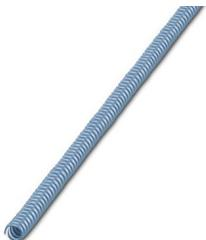
Manguera de protección, material: PU, espiral: PUR Acero para resortes con revestimiento, resistente a los rayos ultravioleta: no, flexible, índice de protección: IP68, color: azul, diámetro interior: 7 mm, Longitud total: 10 m
