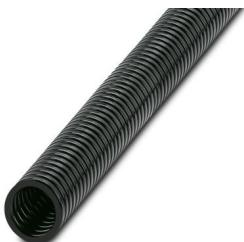
Manguera de protección, material: PA 6, resistente a los rayos ultravioleta: sí, flexible, índice de protección: IP68, color: negro, clase de inflamabilidad según UL 94: HB, diámetro interior: 17 mm, Longitud total: 50 m
