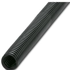
Manguera de protección, material: PA 6, resistente a los rayos ultravioleta: sí, flexible, índice de protección: IP68, color: negro, clase de inflamabilidad según UL 94: V0, diámetro interior: 17 mm, Longitud total: 50 m
