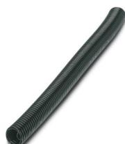
Manguera de protección, material: PA 6, resistente a los rayos ultravioleta: sí, flexible, índice de protección: IP68, color: negro, clase de inflamabilidad según UL 94: HB, diámetro interior: 7 mm, Longitud total: 50 m
