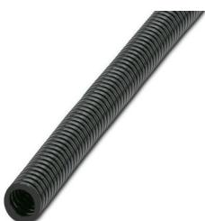
Manguera de protección, material: PA 6, resistente a los rayos ultravioleta: sí, flexible, índice de protección: IP68, color: negro, clase de inflamabilidad según UL 94: V0, diámetro interior: 12 mm, Longitud total: 50 m
