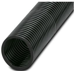
Manguera de protección, material: PA 6, resistente a los rayos ultravioleta: sí, flexible, índice de protección: IP68, color: negro, clase de inflamabilidad según UL 94: HB, diámetro interior: 36 mm, Longitud total: 25 m
