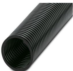
Manguera de protección, material: PA 6, resistente a los rayos ultravioleta: sí, flexible, índice de protección: IP68, color: negro, clase de inflamabilidad según UL 94: V0, diámetro interior: 36 mm, Longitud total: 25 m
