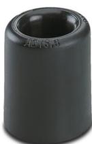
Manguito terminal para protección de cable, material: PA 6, color: negro, clase de inflamabilidad según UL 94: V2, diámetro interior: 10 mm
