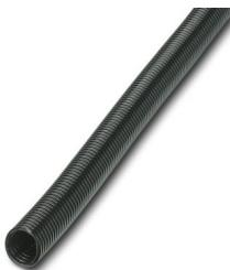
Manguera de protección, material: PA 6, resistente a los rayos ultravioleta: sí, flexible, índice de protección: IP68, color: negro, clase de inflamabilidad según UL 94: V0, diámetro interior: 10 mm, Longitud total: 50 m
