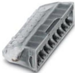
Borne de caja de 8 polos con conexión por resorte, para el cableado sin herramientas mediante técnica de conexión Push-in, para conductores unifilares y multifilares con una sección de entre 0,5 y 2,5 mm<sup>2</sup>, carcasa aislante transparente.
