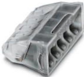
Borne de caja de 5 polos con conexión por resorte, para el cableado sin herramientas mediante técnica de conexión Push-in, para conductores unifilares y multifilares con una sección de entre 0,5 y 2,5 mm<sup>2</sup>, carcasa aislante transparente.
