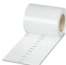
Marcador para bornes, Rollo, blanco, sin rotular, rotulable con: THERMOMARK ROLL 2.0, THERMOMARK ROLL, THERMOMARK ROLL X1, THERMOMARK ROLLMMASTER 300/600, THERMOMARK X1.2, THERMOMARK S1.1, Perforado, clase de montaje: enclavar, encajar en ranura para índice plana, para ancho de borne: 10,2 mm, Número de índices individuales: 10000, altura del campo de texto: 6,35 mm, anchura del campo de texto: 10,15 mm
