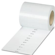
Marcador para bornes, disponible: por líneas, blanco, rotulado según las indicaciones del cliente, clase de montaje: encajar en ranura de etiqueta universal, encajar en ranura para índice plana, para ancho de borne: 10,2 mm
