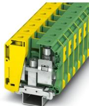
Borna de tierra, número de conexiones: 2, número de polos: 1, tipo de conexión: Conexión por tornillo, Sección de dimensionamiento: 70 mm<sup>2</sup>, sección: 16 mm<sup>2</sup> - 95 mm<sup>2</sup>, tipo de fijación: Pie PE con tornillo de fijación, M6, clase de montaje: NS 35/7,5, NS 35/15, NS 35/15-2,3, NS 32, color: amarillo-verde
