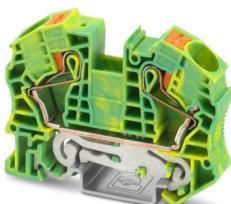
Borna de tierra, número de conexiones: 2, tipo de conexión: Conexión push-in, Sección de dimensionamiento: 16 mm<sup>2</sup>, sección: 0,5 mm<sup>2</sup> - 25 mm<sup>2</sup>, clase de montaje: NS 35/7,5, NS 35/15, color: amarillo-verde
