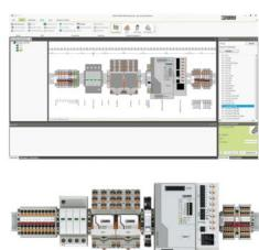
Software de planificación y marcado intuitivo para diseñar regletas de bornes y para la rotulación profesional de materiales de marcado para bornes, conductores, equipos e instalaciones. El software está disponible para su descarga
