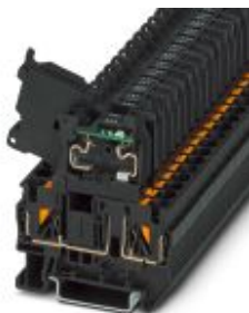
Borne para fusible con palanca, color negro, para cartuchos fusible G de 5 x 20 mm, con LED para 24 V AC/DC
