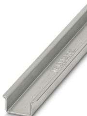
Carril simétrico sin perforar, Variante de embalaje con 10 unidades (20 m), según EN 60715, material: Acero, galvanizado, pasivado de capa gruesa, Perfil estándar 2,3 mm, color: plateado
