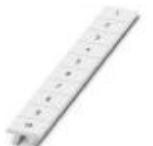
Tira Zack, Tiras, blanco, rotulado, rotulable con: CMS-P1-PLOTTER, Rotulación transversal: números correlativos de 1 ...10, 11 ...20 etc. hasta 91 ...100, clase de montaje: encajar en ranura para índice alta, para ancho de borne: 8,2 mm, superficie útil: 10,5 x 8,15 mm, Número de índices individuales: 10
