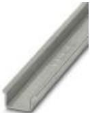
Carril simétrico sin perforar, Perfil estándar 2,3 mm, anchura: 35 mm, altura: 15 mm, según EN 60715, material: Acero, galvanizado, pasivado de capa gruesa, longitud: 2000 mm, color: plateado
