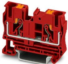
Borne de paso, tensión nominal: 1000 V, corriente nominal: 41 A, número de conexiones: 2, tipo de conexión: Conexión push-in, Sección de dimensionamiento: 6 mm<sup>2</sup>, sección: 0,5 mm<sup>2</sup> - 10 mm<sup>2</sup>, clase de montaje: NS 35/7,5, NS 35/15, color: rojo
