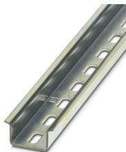
Carril simétrico perforado, Variante de embalaje con 25 unidades (50 m), similar EN 60715, material: Acero, galvanizado, pasivado de capa gruesa, Perfil estándar, color: plateado
