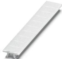
Marcador para bornes, Tiras, blanco, rotulado, rotulable con: CMS-P1-PLOTTER, rotulación longitudinal: U, V, W, N, GND, U, V, W, N, GND, clase de montaje: enclavar, para ancho de borne: 6,2 mm, Número de índices individuales: 10, altura del campo de texto: 10,5 mm, anchura del campo de texto: 6,15 mm
